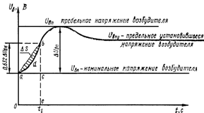
Точка  $b$  определяет время  $t_1$ , по прошествии которого напряжение возбудителя достигает значения  $U_{дн} + 0,632\Delta U_{дп}$ .
